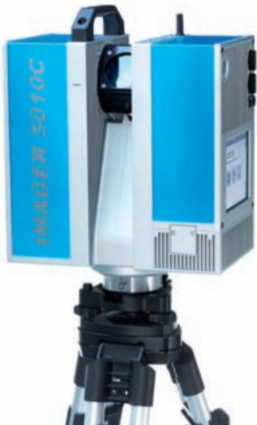
Ryc. 2. Przykładowy model skanera fazowego, wykorzystywanego w technice kryminalistycznej – IMAGER® 5016 firmy Zoller+Fröhlich.
