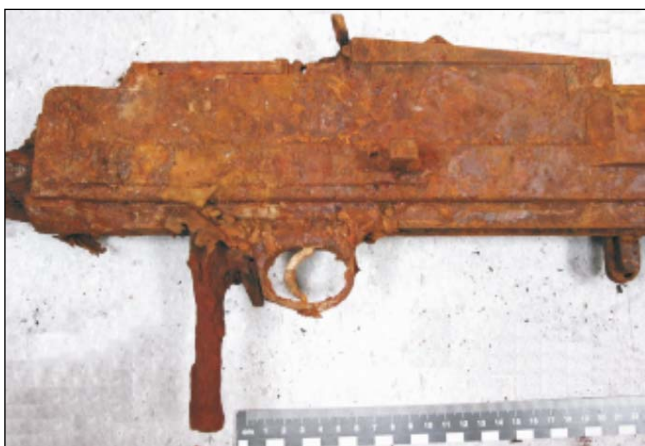
Ryc. 3. Komora zamkowa i chwyt pistoletowy rkm-u BREN w stanie nadesłanym do badań
