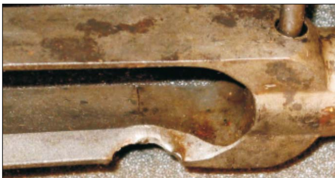
Ryc. 11. Uszkodzenie szyny suwadła – widok z góry, od wewnątrz Fig. 11. Damage of slide rail – upper view from the inside
