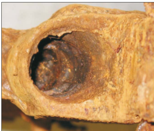
Ryc. 4. Gniazdo lufy rkm-u BREN w stanie nadesłanym do badań
